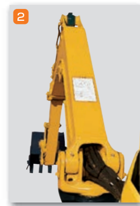
2 油圧ホースの損傷を防ぐため、ブームに内装した外観スッキリのインナーブーム
