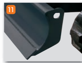
11 大型化され材質に特殊鋼を使い耐久性を高めたブレードカッティングエッジ
